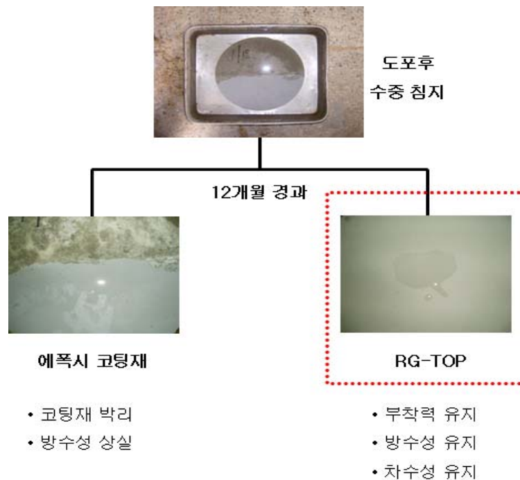
그림 3.13 레미가드 보수공법 표면보호재의 수중 침지실험 결과
