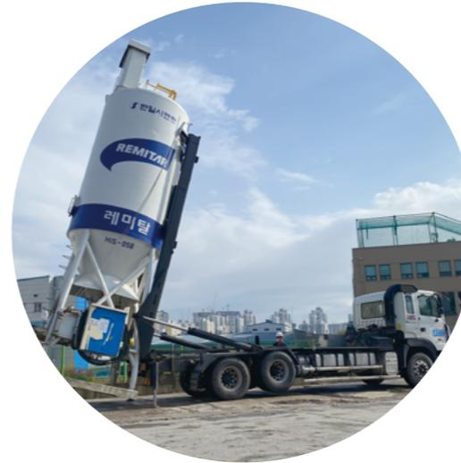
전국의 건설현장에서 작업자들이 우선적으로 찾는 상직적 존재로 자리매김하고 있는 ‘이동식 사일로’는 한일이 추구하는 ‘비포서비스(Before Service)’의 결과물입니다. 사일로는 건설현장 내부바닥이나 옥상에 레미탈을 대량으로 공급하기 위한 설비로 레미탈을 사용하는 고객에게 서비스 형태로 제공되는 장비입니다. 한일은 현장의 요구사항을 수렴하여 품질 개선 연구를 진행한 끝에 시멘트 업계 최초로 자동화된 건축 시공 솔루션을 제공할 수 있었습니다.
